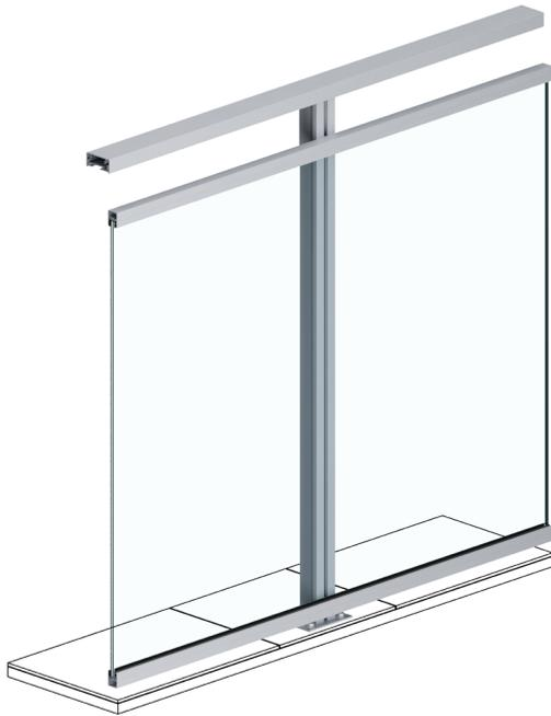
Das Geländersystem basic sorgt für die Sicherheit Ihrer Familie, ohne die Aussicht von Ihrem Haus oder Ihrer Wohnung einzuschränken. Der Hauptteil der Konstruktion besteht aus massiven Aluminiumpfosten. Das Formteil wird zwischen dem oberen und unteren Verglasungsprofil platziert. Die Zusammensetzung des Systems wird durch einen speziellen Handlauf vervollständigt.
