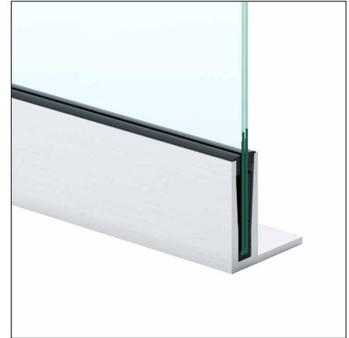
Glasbalustrade, montiert auf einem Aluprofil, dem einzigen Befestigungskomponenten. Klassische Eleganz, Stabilität und Festigkeit – so heißen die Auszeichnungsmerkmale dieses Typs der Balustrade. Das Aluprofil gewährleistet die Befestigung der Ganzglasbalustraden an den Eisenbetongrund. Geeignet für Privathäuser und Öffentlichkeitsgebäude mit der Handlaufast von 0.5-1.5 kN.
